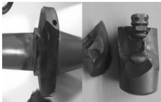
图7 击穿的套管和电容测试端子
